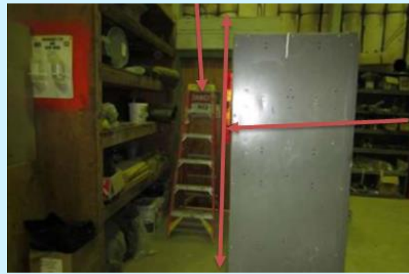
Fig. 2 El empleado usó una escalera de 6 pies para alcanzar una altura de 8 pies 5 pulgadas
