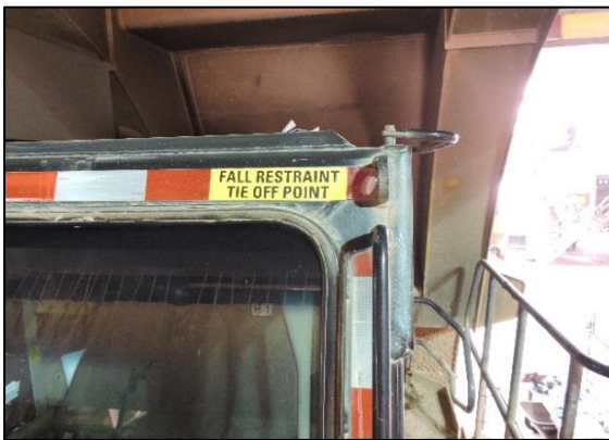
Fig. 17 Punto de sujeción en un camión de remolque
