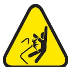
Liberación descontrolada de energía
