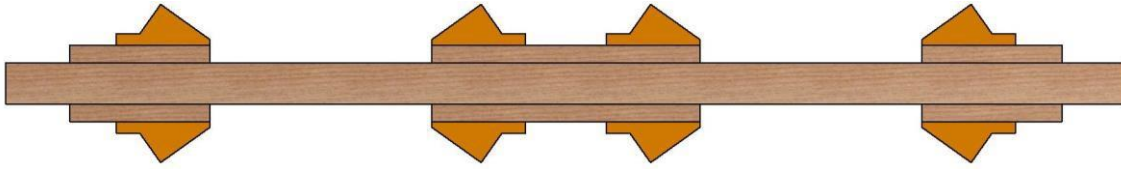
Diagrama 5: Ejemplo de estiba con una cuña de plástico
