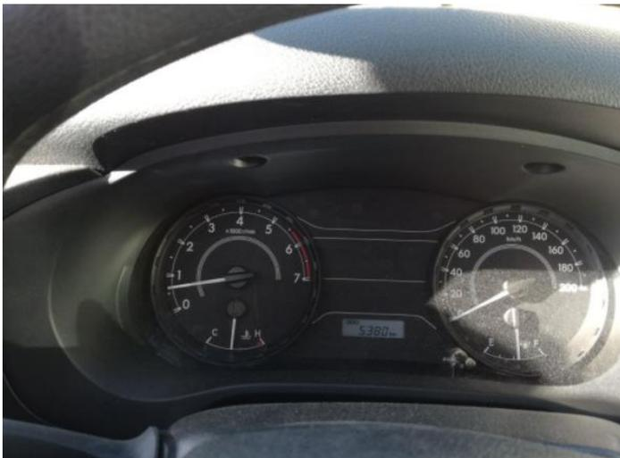
4.- Con el freno de parqueo aplicado, el conductor pone 1ra marcha e intenta partir, esto con la finalidad de confirmar que el vehículo tiene resistencia al movimiento y no llega a partir libremente. No se debe acelerar, solo confirmar que el freno parqueo está funcionando. Luego regresa a neutro y quita el freno de parqueo.
