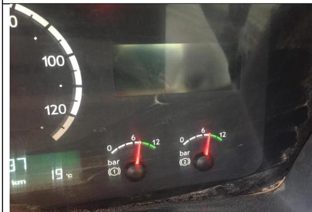
**PASO 5 : PRUEBA DE FRENO DE AIRE**, en este paso se pisa y libera el pedal de freno para verificar que esta actuando la perdida y ganacia de presión de manera instantanea. Estar atento a sonido de fuga de aire.
