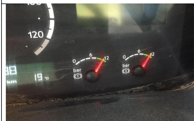
**PASO 7 : ACCION DE DETENCION APLICANDO EL FRENO DE SERVICIO**, es el último paso y consiste en probar la efectividad del freno de servicio, el operador libera el freno de parqueo e inicia marcha del vehiculo, avanza pocos metros y aplica el freno de servicio deteniendo el vehiculo de manera efectiva, esta prueba solo se debe hacer en terreno plano.
