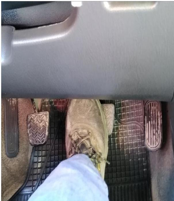
2.-Estando aún estacionado, aplica el pedal de freno de servicio, con la finalidad de confirmar que efectivamente el pedal opone resistencia normal y llega a un fin de carrera, es decir, no se va hasta el fondo, no está largo. También confirmar que el accionamiento del pedal NO esta duro. Estar atento a ruido de fuga de aire (hidrovac).
